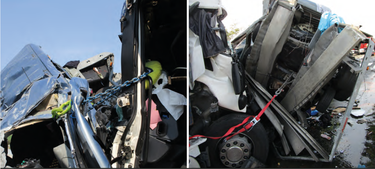
Sicherung des Transporters am Lkw
